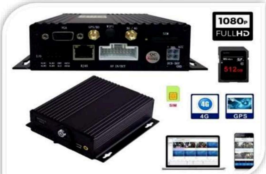
Para visualizar la data de forma manual, se retira la memoria SD se coloca en su PC y se lee con el aplicativo MDVR Player, de forma remota, se conecta el MDVR vía 3G/4G/WIFI al servidor y se visualiza con el aplicativo CMSV6 desde su Smartphone o PC.
